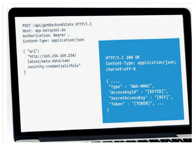
Abbildung 6: Anfrage mit veränderter URL, Server-Side Request Forgery wurde ausgenutzt (Quelle: Frank Uly)
