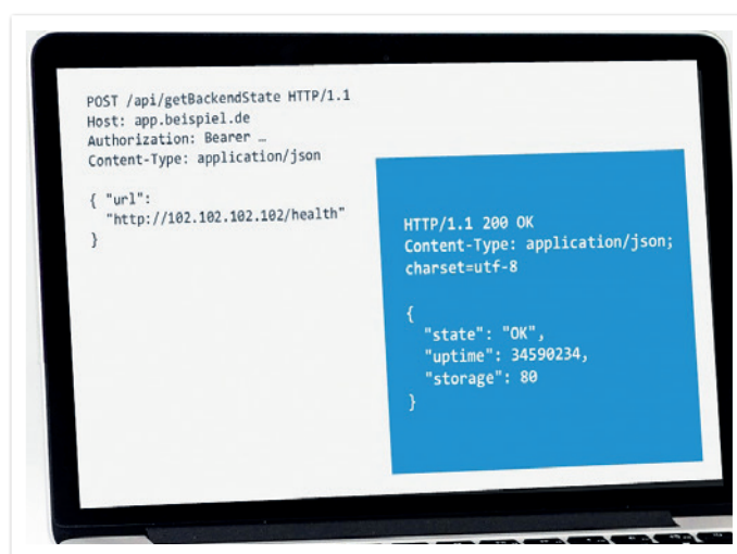
Abbildung 5: Anfrage mit externer URL, potenziell anfällig für Server-Side Request Forgery (Quelle: Frank Uly)
