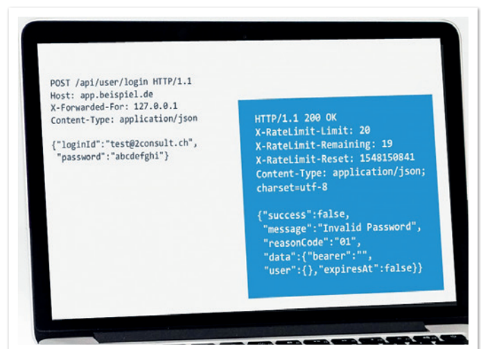
Abbildung 3: Anfrage mit eingefügtem X-Forwarded-For Header (Quelle: Frank Ullly)
