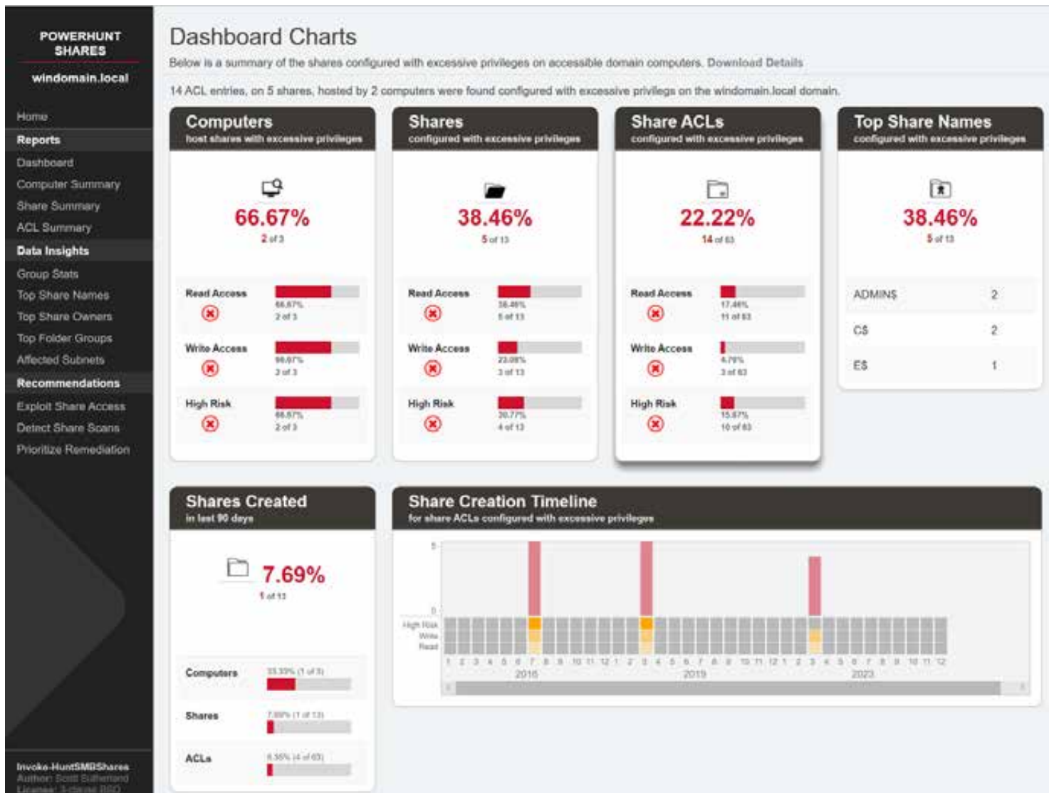
Das PowerHuntShares-Dashboard verrät, wo zu freizügige Rechte eingeräumt wurden und welche Geräte ungehindert zu erreichen sind (Abb. 10).
